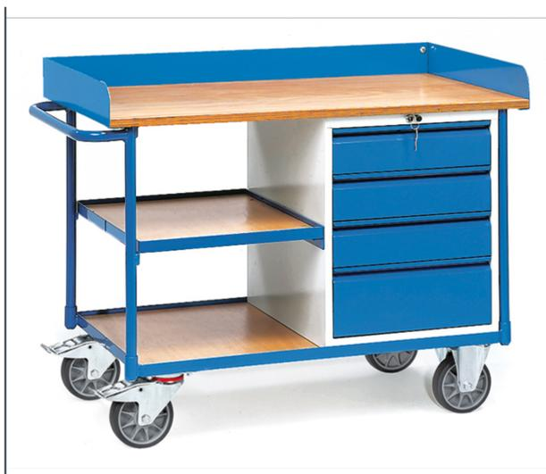
Construction en profilé et tube d'acier, revêtement époxy, caisson gris RAL 7035, armature et tiroirs RAL 5007, plan de travail en contreplaqué de 22 mm avec rebord sur 3 côtés de 80 mm de haut, 1 placard à 4 tiroirs avec serrure centrale (3 tiroirs de 120 mm de haut et 1 tiroir de 180 mm de haut). Charge par tiroir : 25 kg. 2 roues pivotantes et 2 roues fixes à bandage TPE, moyeu à roulement à billes central. Freins sur roues pivotantes conformément à la Norme EN 1757-3.
