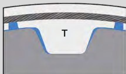
„SE“-Lücke, Reduzierte Lückenform Reduced Backlash „SE“ Tooth Gap
