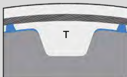
„0“-Lücke, Null-Lückenform Zero Backlash „0“ Tooth Gap
