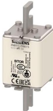
SITOR-Sicherungseinsatz Baugröße 1 450A aR 600V dc/1100V VSI 750V dc UL @MBC 5xIn Schraubkontakte M10 110mm geschlitzte Messer
