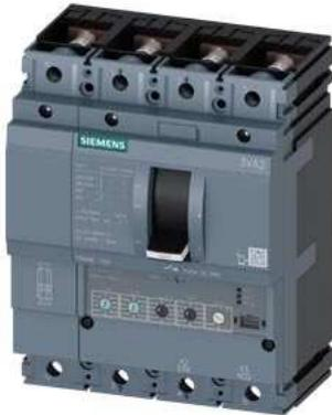
Leistungsschalter 3VA2 IEC Frame 160 Schaltvermögenklasse L Icu=150kA @ 415V 4-polig, Anlagenschutz ETU350, LSI, In=160A Überlastschutz Ir=63A...160A Kurzschlusschutz I<sub>sd</sub>=1,5...10 x I<sub>r</sub>, I<sub>i</sub>=10 x I<sub>n</sub> N-Leiterschutz einstellbar (OFF, 50%, 100%) Schraubenflanschanschluss
