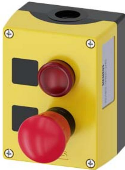
Gehäuse für Befehlsgeräte, 22 mm, rund, Gehäusematerial Kunststoff, Gehäuseoberteil gelb, 2 Befehlsstellen Kunststoff, B=Leuchtmelder rot, LED 24 V, Schraubanschluss, Schild ohne Aufschrift, A=NOT-HALT 40MM DREHENTRIEGELT, Schild ohne Aufschrift, 1S, 1Ö, 1Ö, Schraubanschluss, Bodenbefestigung, oben und unten je 1xM20, Schilder beigelegt
