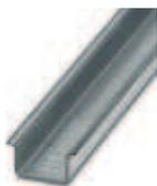
Tragschiene, Material: verzinkt, ungelocht, Höhe 15 mm, Breite 35 mm, Länge: 2 m
