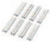
Zackband, Streifen, weiß, beschriftet, beschriftbar mit: Plotter, quer bedruckt: fortlaufende Zahlen 1-10, 11-20 usw. bis 491-500, Montageart: Verrasten in hoher Schildchennut, für Klemmenbreite: 5,2 mm, Schriftfeldgröße: 5,15 x 10,5 mm
