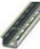
Tragschiene, Material: Stahl verzinkt und dickschichtpassiviert, gelocht, Höhe 15 mm, Breite 35 mm, Länge: 2000 mm
