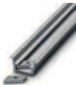
Tragschiene, profil-gezogen, hohe Ausführung, ungelocht 1,5 mm dick, Material: Aluminium, Höhe 15 mm, Breite 35 mm, Länge 2000 mm
