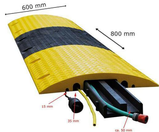
Technische Ansicht: Kabelbrücke Typ 215-35-50 -für D-Schläuche
