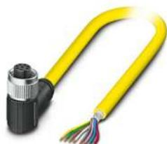
Sensor-/Aktor-Kabel, 8-polig, PVC, gelb, geschirmt, freies Leitungsende, auf Buchse gewinkelt M12, Kodierung: A, Kabellänge: 10 m
