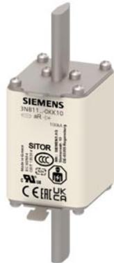
SITOR-Sicherungseinsatz Baugröße 1 250A aR 440V dc/600V VSI 500V dc UL @MBC 6xIn Messerkontakte
