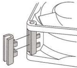
Distanzhalter aus glasfaserverstärktem Kunststoff. Zur Montage mit Schrauben über beide Lüfter-Befestigungsflansche.
