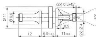
Gummi-Montagestopfen für Lüfter mit Bohrungs- $\varnothing$  4,3  $\pm$ 0,2 mm und Flanschdicke 3 ... 5,5 mm. Für Trägerblech mit Bohrungs- $\varnothing$  6,5  $\pm$ 0,15 mm und Blechdicke 1 ... 2 mm.
