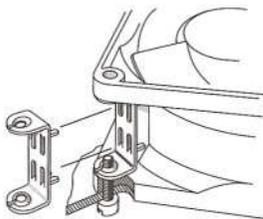
Bügfeder Mutter aus rostgeschütztem Federstahl. Zur Befestigung von Lüftern mit einer Gewindeschraube 3,5 DIN EN ISO 1478 (7970).
