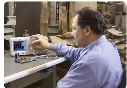
Abbildung 3. Automatische PASS/FAIL-Maskentests sind nur einer von vielen Gründen dafür, warum die Oszilloskope der Familie 1000 wie geschaffen sind für Anwendungen in der Produktion und im Service.
