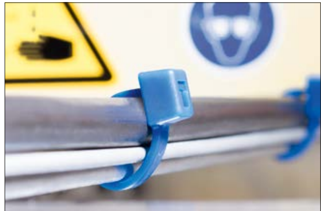
T-serie bundelbanden vervaardigd uit E/TFE, voor hoge chemische bestendigheid, tot +170 °C.
