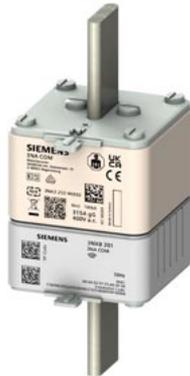
NH-Sicherungseinsatz 3NA COM mit Messfunktion Baugroesse 2 In 160A Un 400V Betriebsklasse gG mit Elektronikmodul spannungsführenden Griffflaschen und Stirnkennmelder Bitte Funkzulassung beachten! Länderliste: siehe Zertifikate
