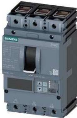
Leistungsschalter 3VA2 IEC Frame 160 Schaltvermögenklasse M Icu=55kA @ 415 V 3-polig, Motorschutz ETU550M, LSI, In=63A Überlastschutz Ir=25A ...63A Kurzschlusschutz ISD=1,2... 15x In,li=3...15x In Klemmenanschluss
