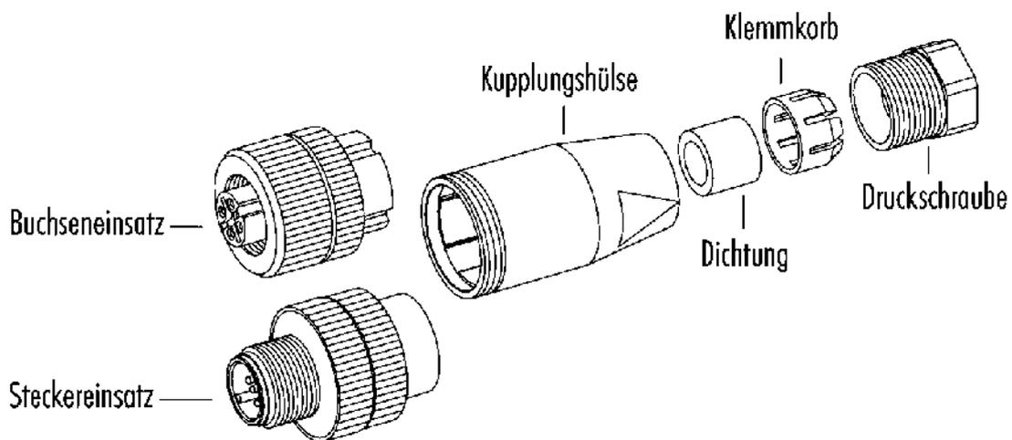
Material der Gewinderinge: Kunststoff, Zink Druckguss, Edelstahl
