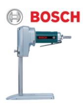
Bosch-Druckluft-Schaumstoffsäge zum genauen Zuschneiden von Schaumstoff und ähnlichen Materialien. Sägeblattführung und Sägeblätter müssen extra bestellt werden.
