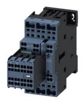
Leistungsschütz, AC-3 25 A, 11 kW / 400 V 2 S + 2 Ö, AC 110 V, 50 Hz, 3-polig, Baugröße S0 Federzuganschluss
