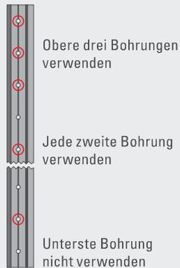
3. Mit geeigneten Schrauben an Unterkonstruktion montieren. Bei rot markierten Bohrungen ist das Profil zu verschrauben.
