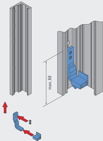
1. Kontaktschutz auf Auflagerkonsole pressen. Dann Auflagerkonsole durch die Nut führen und mit Gewindestiften M5 x 5 verschrauben. Anzugsmoment ca. 6 Nm.
