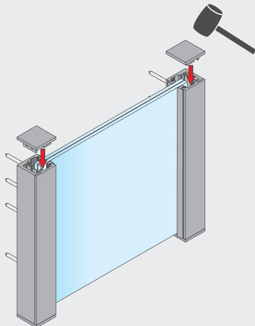
8. Stiftschrauben M5 so weit eindrehen, dass beim Einstecken des Deckels in das BALMERO-Profil eine Klemmwirkung erreicht wird. Deckel in das BALMERO-Profil, ggf. mit Kunststoffhammer einschlagen. Fertig!
