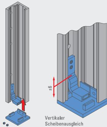
2. Abschlusdeckel unten mit Gewindestiften M5 x 5 an Grundprofil verschrauben. Anzugsmoment ca. 6 Nm.
