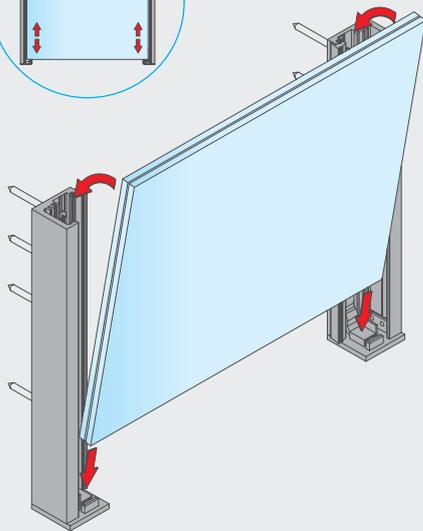
5. Glasscheibe auf Auflagerkonsole mit montiertem Kontaktschutz setzen und mit Wasserwaage ausrichten. Dabei auf den minimalen Glaseinstand von 18 mm achten.
