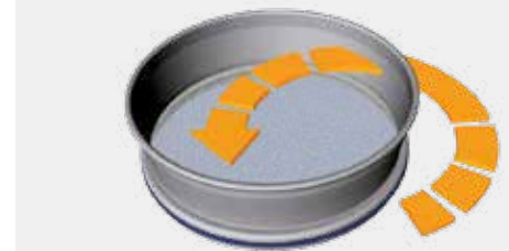
Prinzip der Plansiebung
