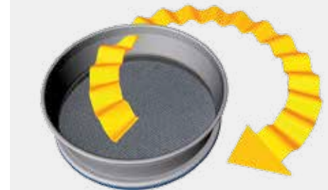
Prinzip der Klopf siebung
