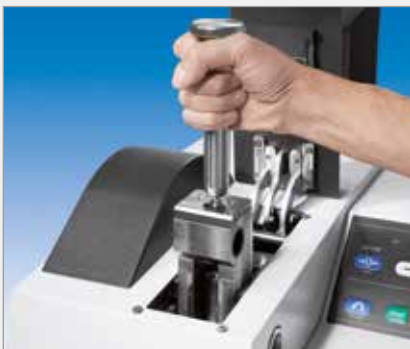
Einfache Entnahme des vorderen Brecharms ohne Werkzeug
