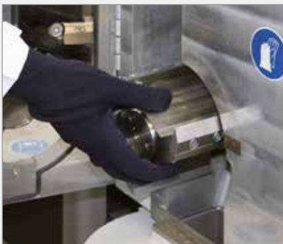
Push-Fit Rotoren für schnelle und einfache Reinigung
