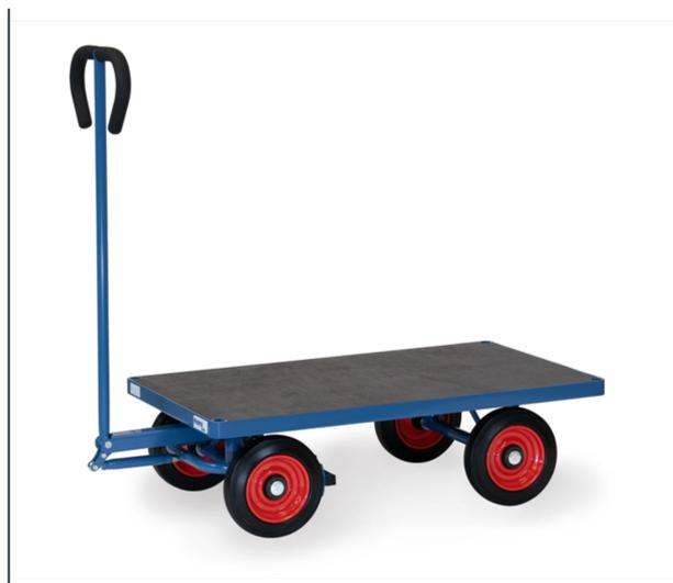
En tube d'acier soudé, revêtement époxy bleu RAL 5007. plateau en contreplaqué hydrofuge. Essieu avec timon. Roues à bandage caoutchouc, moyeu à roulement à rouleaux. Poignée sécurisée avec revêtement souple remontant automatiquement en position verticale. Blocage automatique de l'essieu avant, conformément à la Norme EN 1757-3.
