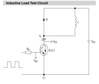
L = 1.87 mH, V\_{CE} = 400 V, V\_{GE} = 15 V, I\_{C} = 30 A, R\_G = 10  $\Omega$
