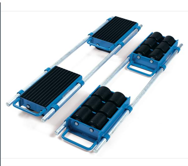
Für den leichten und sicheren Transport von Maschinen und anderen schweren Gegenständen. Stabile Stahl-Schweißkonstruktion, mit Handgriffen aus Rundstahl, pulverbeschichtet blau RAL 5007. Tragplatten mit rutschhemmender Gummiauflage versehen. Große Nylonrollen kugelgelagert. Verstellbereich: 700-1190 mm.
