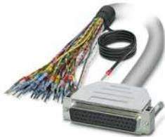
Konfektioniertes, geschirmtes Rundkabel; Anschluss 1: Einzeladern (50-polig) (Die Adern sind beschriftet und mit Aderendhülsen versehen. Das Schirmgeflecht ist auf ein separates Kabelende herausgeführt.); Anschluss 2: D-SUB-Buchsenleiste (1x 50-polig); Kabellänge: 6 m
