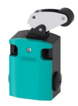
Positionsschalter Metallgehäuse 56 mm breit Geräteanschluss 3x (M20x 1,5) 2S/1Ö Schleichkontakte Winkelrollenhebel, Metallhebel und Kunststoffrolle 22 mm
