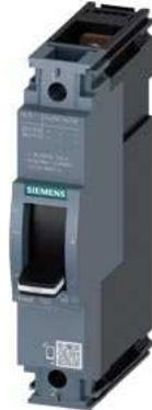
Leistungsschalter 3VA1 IEC Frame 160 Schaltvermögenklasse S I<sub>cu</sub>=36kA @ 240V 1-polig, Anlagenschutz TM210, FTFM, I<sub>n</sub>=25A Überlastschutz I<sub>r</sub>=25A fest eingestellt Kurzschlusschutz I<sub>i</sub>=12,8 x I<sub>n</sub> Schraubenflachanschluss
