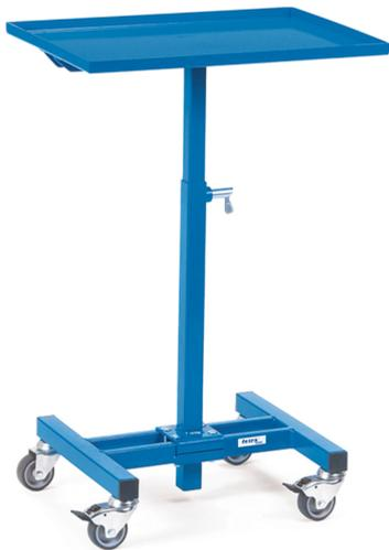
Für Kunststoffkästen, Stahlblechkästen, Drahtkörbe usw., höhenverstellbar und fahrbar. Profilstahl-/Rohrkonstruktion mit Stahlblechplattform mit allseitigem Rand 20 mm hoch. Nicht neigbar. Höhenverstellbar im Raster von 25 mm. Pulverbeschichtet brillantblau RAL 5007. 4 Lenkrollen mit TPE-Bereifung, Naben mit Gleitlagerung. Feststeller an 2 Lenkrollen gemäß der Europäischen Norm EN 1757-3 (Sicherheit von Plattformwagen).
