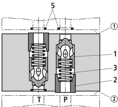
Schnitt 1: Typ Z1S 6 F (Durchgangsventil)
