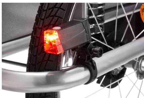
Vue détaillée: Eclairage LED
