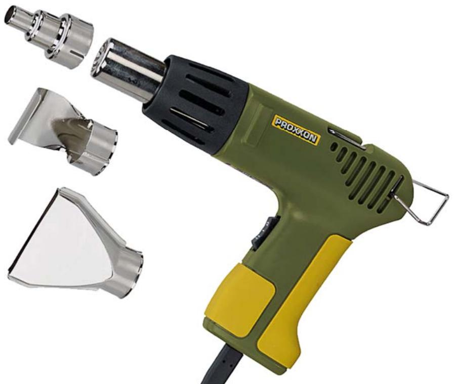
Gehäuse aus glasfaserverstärktem POLYAMID mit Weichkomponenten im Griffbereich und Stellflächen für den stationären Einsatz. Ein leistungsstarkes Heizelement sorgt für konstante Temperatur in 2 Stufen bei einem Luftdurchsatz von ca. 180 l/ min. Eingebauter Thermostat für Sicherheit gegen Überhitzung.
