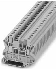
Bauelementreihenklemme, zum Einbau von selbst wählbaren Bauelementen, Nennspannung: 800 V, Nennstrom: 0,5 A, Anschlussart: Schraubanschluss, Bemessungsquerschnitt: 1 mm<sup>2</sup>, Querschnitt: 0,14 mm<sup>2</sup> - 6 mm<sup>2</sup>, Montageart: NS 35/7,5, NS 35/15, Farbe: grau
