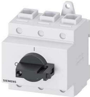
SENTRON, Lasttrennschalter 3LD, Hauptschalter, 3-polig, I<sub>n</sub>: 125 A, Betriebsleistung / bei AC-23 A bei 400V: 45 kW, Verteilereinbau, Knebelantrieb, schwarz, Handhabe direkt am Schalter
