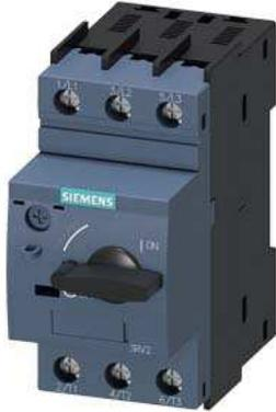
Leistungsschalter Baugröße S00 für den Trafoschutz A-Auslöser 0,55...0,8 A N-Auslöser 16 A Schraubanschluss Standardschaltvermögen
