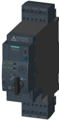
SIRIUS, KOMPAKTABZWEIG, DIREKTSTARTER 400 V, AC/DC 24 V, 50 ... 60 HZ, 8 ... 32 A, IP20, ANSCHLUSS HAUPTSTROMKREIS: FEDERZUGANSCHLUSS, ANSCHLUSS HILFSSTROMKREIS: STECKBAR, OHNE KLEMMEN
