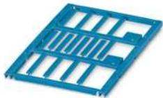
Kabelmarker, Matte, blau, unbeschriftet, beschriftbar mit: BLUEMARK ID COLOR, BLUEMARK ID, BLUEMARK CLED, PLOTMARK, CMS-P1-PLOTTER, Montageart: einschieben, Kabeldurchmesserbereich: 1,5 ... 14 mm, Schriftfeldgröße: 30 x 4 mm, Anzahl der Einzelschilder: 16
