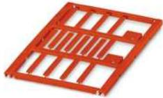
Kabelmarker, Matte, rot, unbeschriftet, beschriftbar mit: BLUEMARK ID COLOR, BLUEMARK ID, BLUEMARK CLED, PLOTMARK, CMS-P1-PLOTTER, Montageart: einschieben, Kabeldurchmesserbereich: 1,5 ... 14 mm, Schriftfeldgröße: 30 x 4 mm, Anzahl der Einzelschilder: 16
