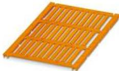
Leitermarker, Matte, orange, unbeschriftet, beschriftbar mit: TOPMARK NEO, TOPMARK LASER, BLUEMARK ID COLOR, BLUEMARK ID, BLUEMARK CLED, THERMOMARK PRIME, THERMOMARK CARD 2.0, THERMOMARK CARD, Montageart: einschieben, Kabeldurchmesserbereich: 1,5 ... 14 mm, Schriftfeldgröße: 30 x 4 mm, Anzahl der Einzelschilder: 30
