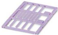
Kabelmarker, Matte, violett, unbeschriftet, beschriftbar mit: BLUEMARK ID COLOR, BLUEMARK ID, BLUEMARK CLED, PLOTMARK, CMS-P1-PLOTTER, Montageart: einschieben, Kabeldurchmesserbereich: 1,5 ... 14 mm, Schriftfeldgröße: 30 x 4 mm, Anzahl der Einzelschilder: 16
