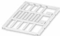
Kabelmarker, Matte, weiß, unbeschriftet, beschriftbar mit: BLUEMARK ID COLOR, BLUEMARK ID, BLUEMARK CLED, PLOTMARK, CMS-P1-PLOTTER, Montageart: einschieben, Kabeldurchmesserbereich: 1,5 ... 14 mm, Schriftfeldgröße: 30 x 4 mm, Anzahl der Einzelschilder: 16
