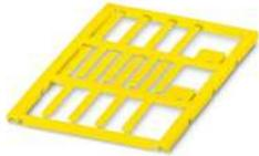
Kabelmarker, Matte, gelb, unbeschriftet, beschriftbar mit: BLUEMARK ID COLOR, BLUEMARK ID, BLUEMARK CLED, PLOTMARK, CMS-P1-PLOTTER, Montageart: einschieben, Kabeldurchmesserbereich: 1,5 ... 14 mm, Schriftfeldgröße: 30 x 4 mm, Anzahl der Einzelschilder: 16
