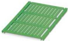
Leitermarker, Matte, grün, unbeschriftet, beschriftbar mit: TOPMARK NEO, TOPMARK LASER, BLUEMARK ID COLOR, BLUEMARK ID, BLUEMARK CLED, THERMOMARK PRIME, THERMOMARK CARD 2.0, THERMOMARK CARD, Montageart: einschieben, Kabeldurchmesserbereich: 1,5 ... 14 mm, Schriftfeldgröße: 30 x 4 mm, Anzahl der Einzelschilder: 30
