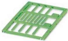
Kabelmarker, Matte, grün, unbeschriftet, beschriftbar mit: BLUEMARK ID COLOR, BLUEMARK ID, BLUEMARK CLED, PLOTMARK, CMS-P1-PLOTTER, Montageart: einschieben, Kabeldurchmesserbereich: 1,5 ... 14 mm, Schriftfeldgröße: 30 x 4 mm, Anzahl der Einzelschilder: 16
