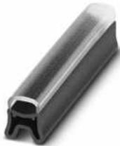
Ader-Bezeichnungsträger, transparent/schwarz, unbeschriftet, Montageart: aufschieben, Kabeldurchmesserbereich: 2 ... 4 mm, Schriftfeldgröße: 30 x 4 mm
