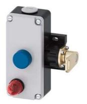
Seilzugschalter mit Hebel Metallgehäuse, 2 x M25 x1,5; 2S+2Ö, Verrastung nach EN13850 und Druckknopfentriegelung mit LED-Lampe rot DC 24 V, 2-seitige Betätigung, für Seillängen bis 2 x 100 m
