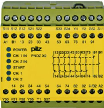
Sicherheitsschaltgerät (standalone), Eingänge: 1/2-kanalige Beschaltung mit/ohne Querschlusserkennung, Ausgänge: 7 S, 2 Ö, 2 HL, automatischer/manueller/überwachter Start und automatischer Start mit Anlaufzeit, UB = 24 V AC/DC, Breite: 90 mm, Schraubklemmen integriert, Überwachung von Not-Halt, Schutztüren.
