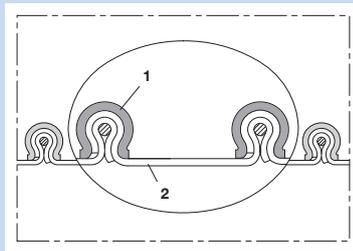
Tuyau avec profilé de serrage (tuyau clippé) pour particules incandescentes ou étincelles de soudage, tenant jusque 280°C
