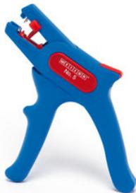
Die WEICON-Abisolierzange No. 5 verfügt über einen verstellbaren Längenanschlag von 5 – 12 mm. Dadurch werden alle flexiblen und massiven Leiter von 0,2 – 6,0 mm<sup>2</sup> (24 – 10 AWG) abisoliert. Der Längenanschlag kann bei Bedarf herausgenommen werden. Ein gut zugänglicher Seitenschneider ist in das Werkzeug integriert, der bis zu einem Kabeldurchmesser von 2 mm genutzt werden kann und es verfügt über wechselbare Klingen. Das geringe Gewicht der No.5 sorgt für ein ermüdungsfreies Arbeiten.
