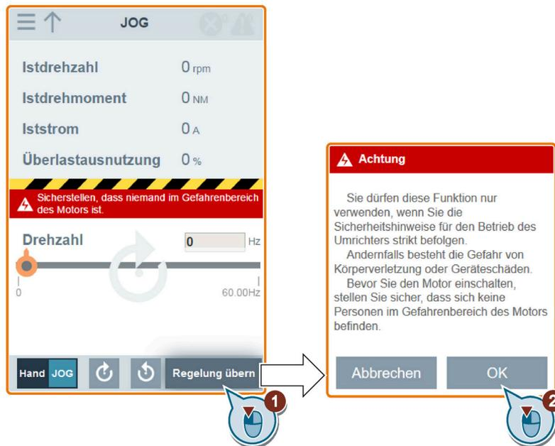
3. Identifizieren Sie die Motordaten. Der nachfolgend gezeigte Schritt erscheint nur, wenn Sie entweder auf der Schnellinbetriebnahmeseite (Seite 160) oder auf der Parameterseite (Seite 165) P1900 = 2 gesetzt haben.
