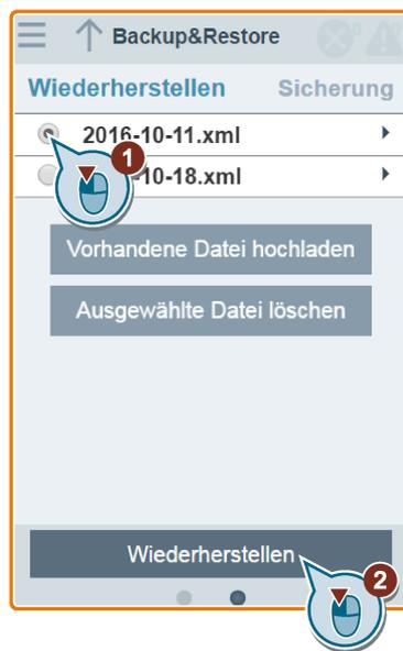
2. Der Wiederherstellungsvorgang ist beendet, wenn das folgende Fenster angezeigt wird. Wenn auf der Webseite angegeben wird, dass die Wiederherstellung fehlgeschlagen ist, können Sie die Wiederherstellung erneut ausführen. Anschließend haben Sie die Möglichkeit, im folgenden Fenster die Parametereinstellungen im nicht-flüchtigen Speicher zu speichern:
