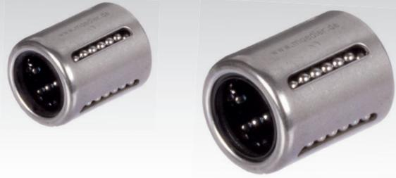
Marken-Kugelbuchsen der ISO-Reihe 1 (Kompakt-Reihe) in hoher Qualität. Mantel aus Stahl, Kugelkäfig aus Kunststoff. Verwendbar mit kundenseitigen Gehäusen oder als Ersatz in unseren Linearkugellagereinheiten ISO-Reihe 1.
