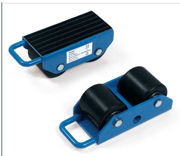
Construction solide en acier avec poignée en tube d'acier, revêtement époxy bleu RAL 5007. Platine recouverte de caoutchouc antidérapant. Pour un transport aisé et sûr d'objets lourds tels que : bacs, caisses, machines, etc. Grands galets en nylon à roulement à billes. Dimensions extérieures (L x l x H mm) : 275 x 120 x 100 mm. Ø roues x largeur mm : 85 x 90 mm. Livraison : 1 pièce
