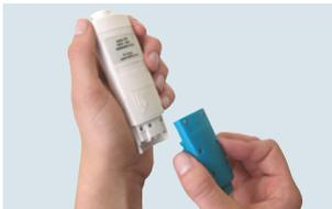
Einfache Sondentauschmöglichkeit bei testo-ph1/-ph2/-ph3
