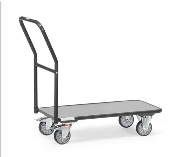
Stahlrohr, Schweißkonstruktion, pulverbeschichtet, anthrazitgrau RAL 7016. Plattform Holzwerkstoffplatte, Oberfläche mittelgrau. 2 Lenk- und 2 Bockrollen, TPE-Bereifung, Naben mit Rillenkugellager. Feststeller an den Lenkrollen, gemäß der Europäischen Norm EN 1757-3 (Sicherheit von Plattformwagen).
