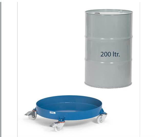
Fassroller für stehenden Transport von 200-Liter Stahlblechfässern. Verschweißte Stahlkonstruktion, pulverbeschichtet brillantblau RAL 5007. Stahlblechwanne öldicht verschweißt. Innen-Ø 630 mm. Rand 80 mm hoch. 4 Lenkrollen, 2 Stück mit Feststeller, Räder Polyamid, Naben mit Gleitlagerung.
