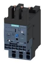
Überlastrelais 3...12 A elektronisch für Motorschutz Baugröße S0, CLASS 10E Schützanbau Hauptstromkreis: Federzugklemme Hilfsstromkreis: Federzugklemme Hand-Automatik-RESET
