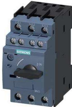
Leistungsschalter Baugröße S0 für den Motorschutz, CLASS 10 A-Auslöser 1,4...2 A N-Auslöser 26 A Schraubanschluss Standardschaltvermögen mit querliegenden Hilfsschalter 1S+1Ö
