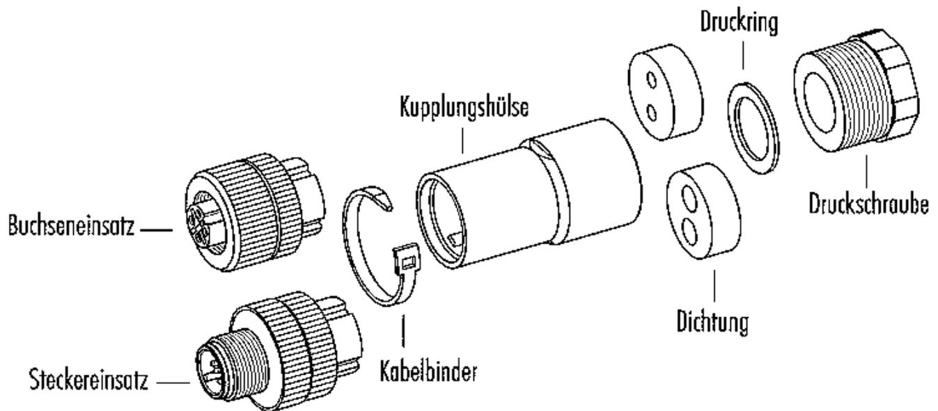
Material der Gewinderinge: Kunststoff, Zink Druckguss, Edelstahl
