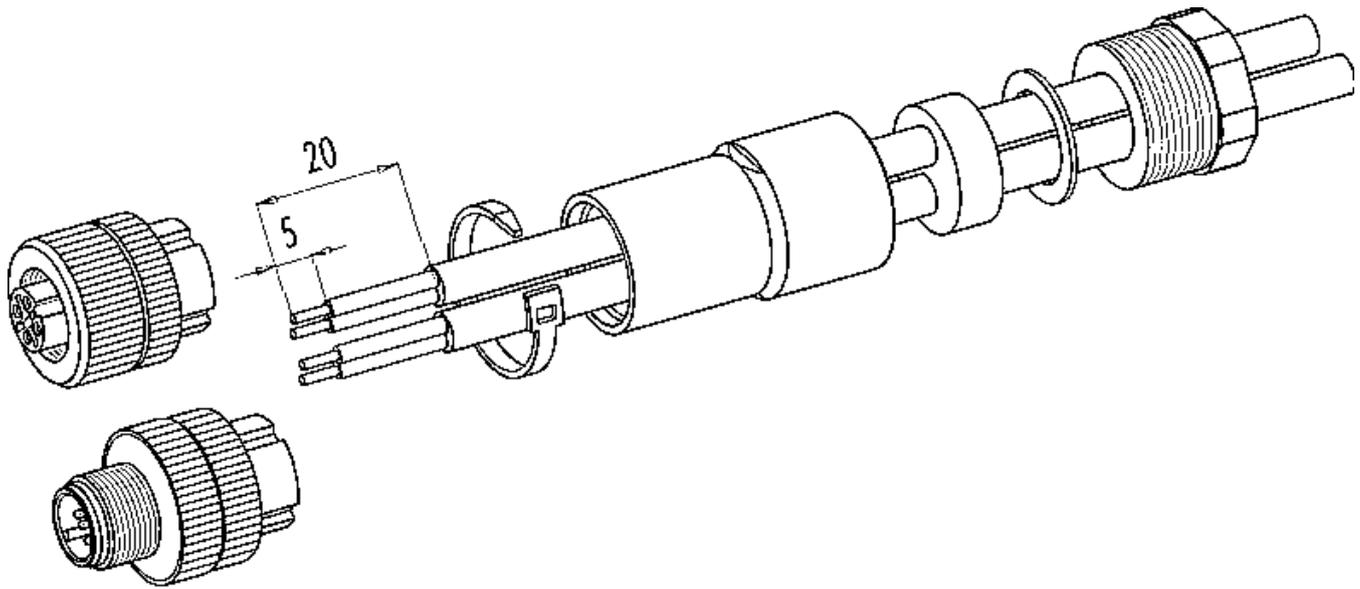
Material der Gewinderinge: Kunststoff, Zink Druckguss, Edelstahl
