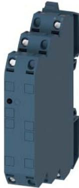
Trennwandler AC/DC 24-240 V, 3-Wege-Trennung Eingang: 0-60 mV, 0-100 mV 0-300 mV, 0-500 mV, 0-1 V 0-20 V, 2-10 V, 0-5 mA, 0-10 mA 2-10 V, 0-5 mA, 0-10 mA 0-20mA, 4-20mA, +5mA, +20mA Ausgang: 0 - 10 V, 0/4 - 20 mA Schraubanschluss
