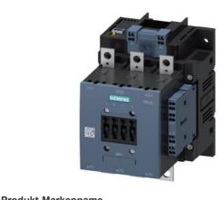
Bahnschütz, AC-3 115 A, 55 kW / 400 V Spule DC 110 V x (0,7-1,25) SPS Eingang 24-110 V DC Hilfskontakte 2 S + 2 Ö 3-polig Baugröße S6 Schienenanschlüsse Spulenanschluss: Federzuganschluss
