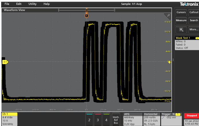
Applicazione di limiti al test delle maschere in base al segnale di riferimento "golden"
